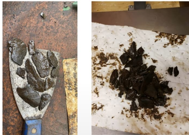
Figura 10 Derrumbes tabulares reportados en el pozo M-2 (izquierda) y M-2ST (derecha)
