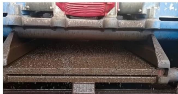
Fig. 5. Imágenes de salida de recorte durante la perforación sección 12 ¼” en pozo M-8.
