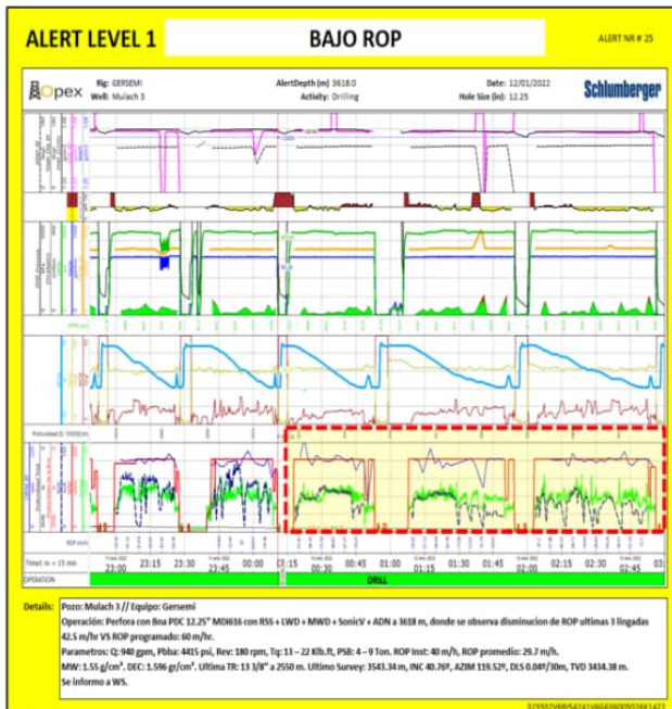
Fig. 19. Imagen de emisión alertas por bajo ROP durante la perforación de la sección 12 ¼", pozo M-3.
